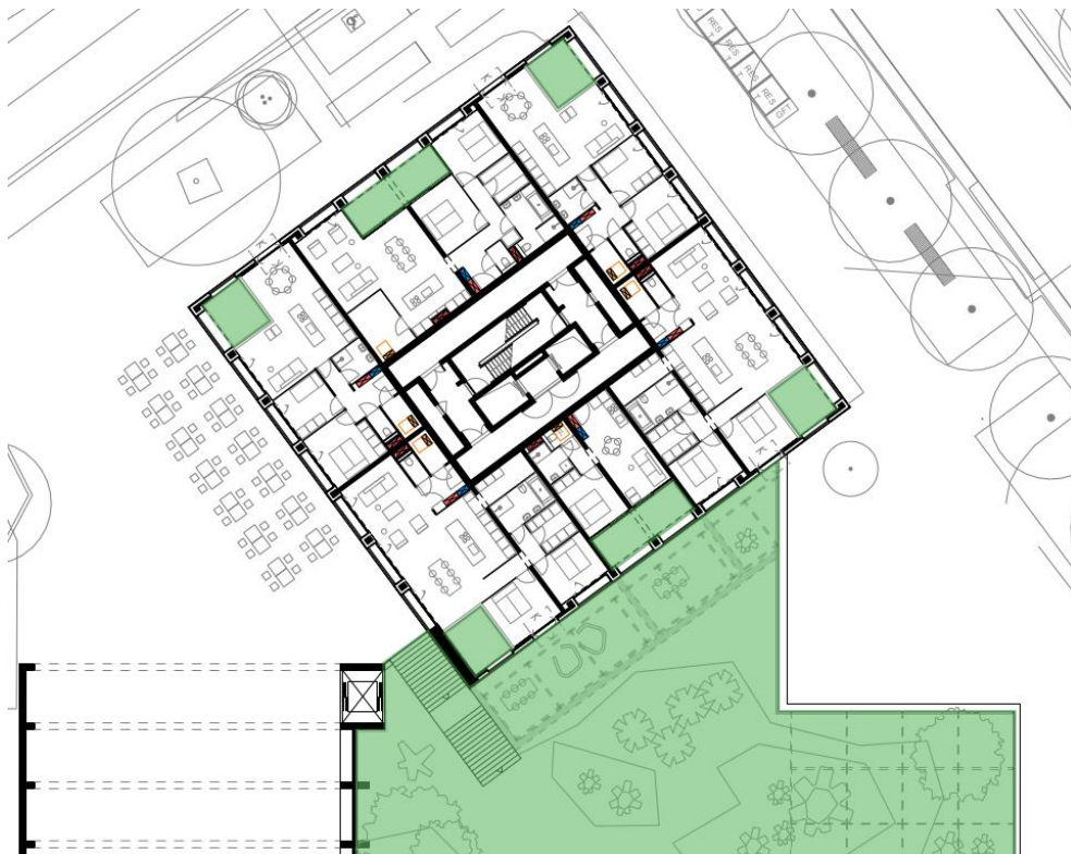
Figuur 5-4 Principe-plategrond - akoestisch gunstige indeling en geluidluwe buitenruimten (groen) bij toren C
